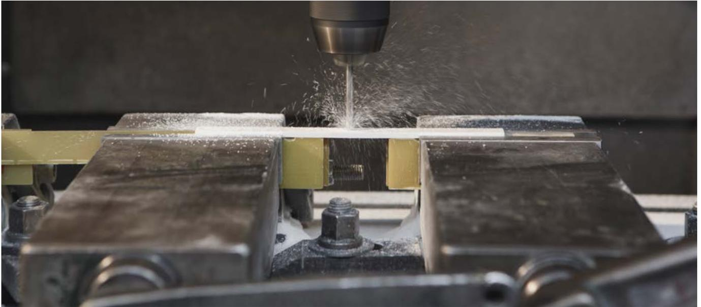
Duroplastischer Werkstoff, hergestellt aus Glasgewebe oder Glasrovinggewebe als Trägermaterial und Polyester-, Epoxid, Melamin-, Silikonharzen als Bindemittel. Hohe mechanische Festigkeiten und hervorragende elektrische Isoliereigenschaften zeichnen diese Werkstoffgruppe aus. In vielen Bereichen wie Schaltanlagenbau, Verkehrstechnik, Fahrzeugbau, Anlagenbau und Medizintechnik kommen diese Werkstoffe zum Einsatz.
