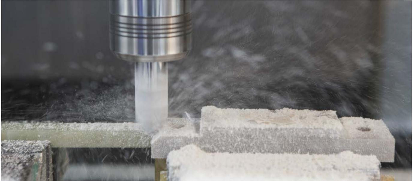
Duroplastischer Schichtpresstoff, hergestellt aus Baumwollgewebepapieren als Trägermaterial und Phenol-/Formaldehyd-Harz als Bindemittel. Dieser hochwertige Werkstoff eignet sich aufgrund seiner guten mechanischen Eigenschaften, wie hohe Verschleißfestigkeit, Geräusch- und Schwingungsdämpfung, für vielseitige Einsatzzwecke im Maschinenbau.
