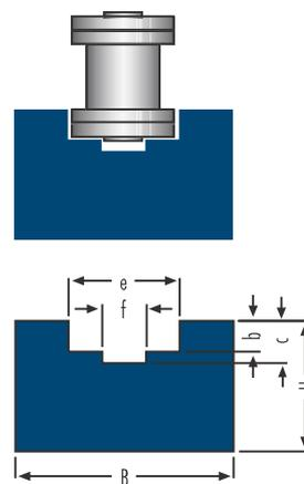
**Profil C für Einfach-Rollenketten / Standardlänge: 2.000mm**
