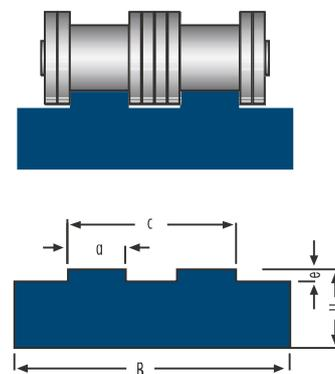
**Profil B für Einfach-Rollenketten / Standardlänge: 2.000mm**
